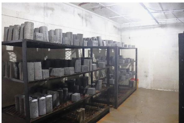
Hidratação sendo realizada nos corpos de prova na Câmara Úmida
