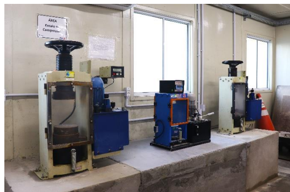
Prensas utilizadas para o teste de resistência dos corpos de prova
