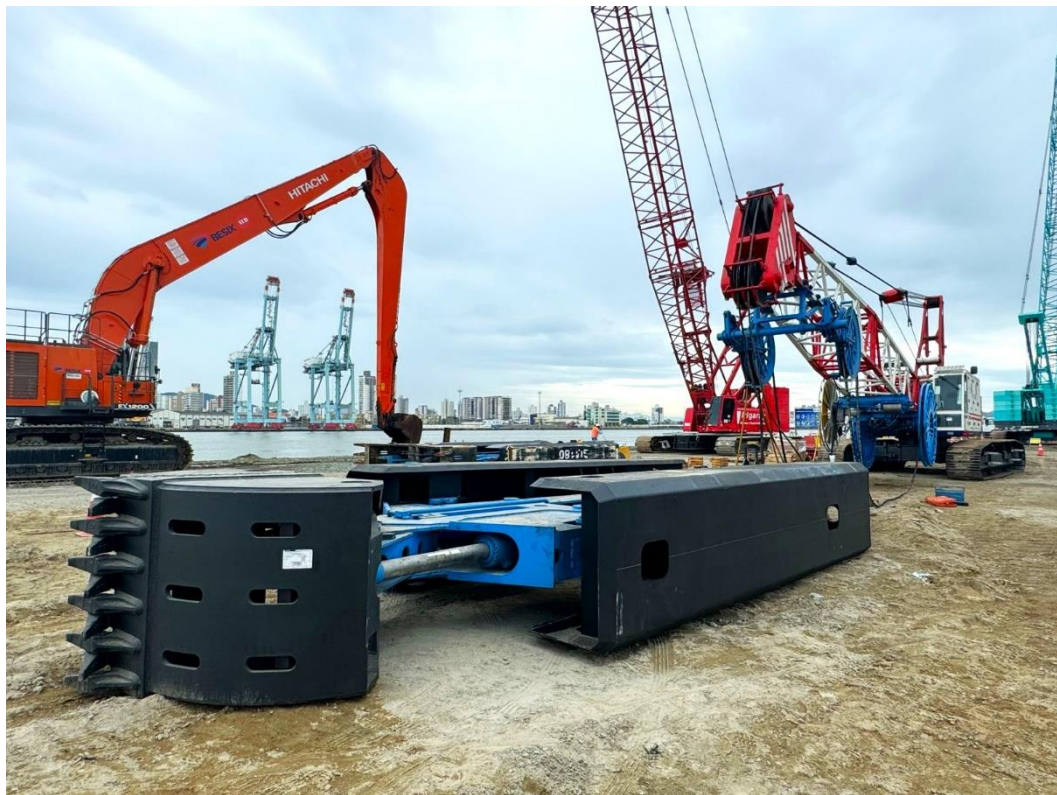
Diaphragm Wall Grab, equipamento para execução da parede de diafragma
