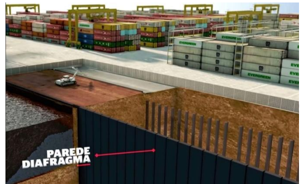
Modelo ilustrado da parede diafragma
