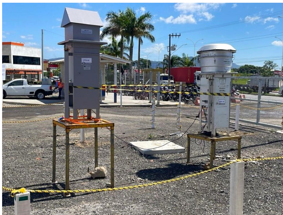
Amostrador de grande volume (à esquerda) e um separador inercial de partículas (à direita), que realizam o monitoramento de emissões atmosféricas
