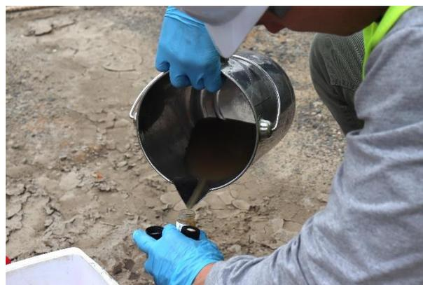
*Coleta de amostra de água subterrânea sendo realizada no poço do canteiro de obras*
