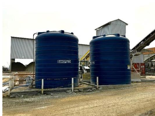
*Sistema de decantação e caixas d'água utilizadas para armazenar a água tratada*
